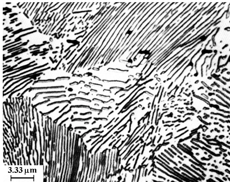
Figura 1.- Perlita laminar formada isotérmicamente a 978 K en un acero eutectoide (30).
