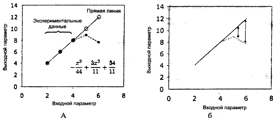
Рис. 10. Две функции, которые точно соответствуют экспериментальным данным (2, 4, 6), экстраполируют различно
