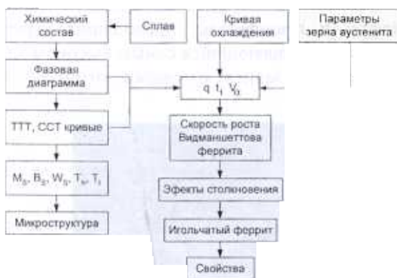
Рис. 2. Блок-схема расчетов микроструктуры и свойств сварного шва
