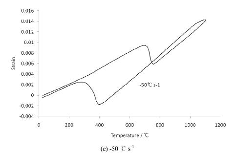
Fig. 3.6: Dilatation curves of the 0.5Mn alloy for each cooling rate (a) -150  $^{\circ}$ C s<sup>-1</sup> (b) -125  $^{\circ}$ C s<sup>-1</sup> (c) -100  $^{\circ}$ C s<sup>-1</sup> (d) -75  $^{\circ}$ C s<sup>-1</sup> (e) -50  $^{\circ}$ C s<sup>-1</sup>
