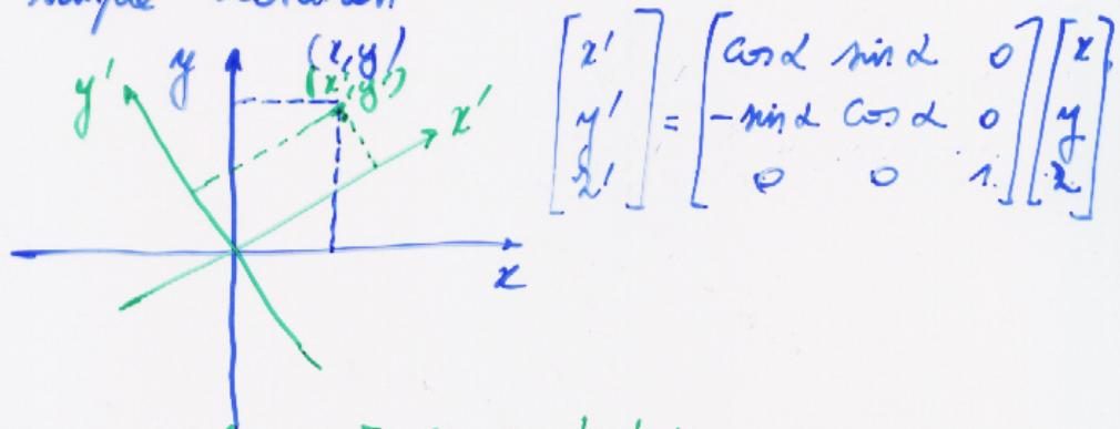
$$\begin{bmatrix} x' \\ y' \\ z' \end{bmatrix} = \begin{bmatrix} \cos \theta & \sin \theta & 0 \\ -\sin \theta & \cos \theta & 0 \\ 0 & 0 & 1 \end{bmatrix} \begin{bmatrix} x \\ y \\ z \end{bmatrix}$$
