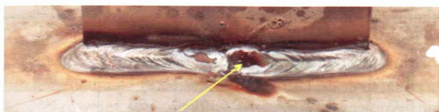
Rys. 2. Lokalizacja początku/końca spawania dla złącza krzyżowego ze spoiną pachwinową
